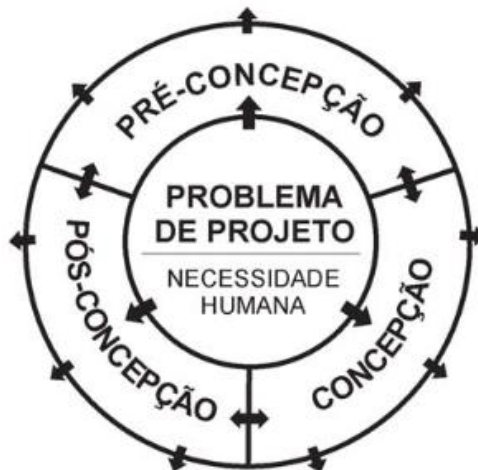
Ilustração 8: Estrutura radial representando o método MD3E
